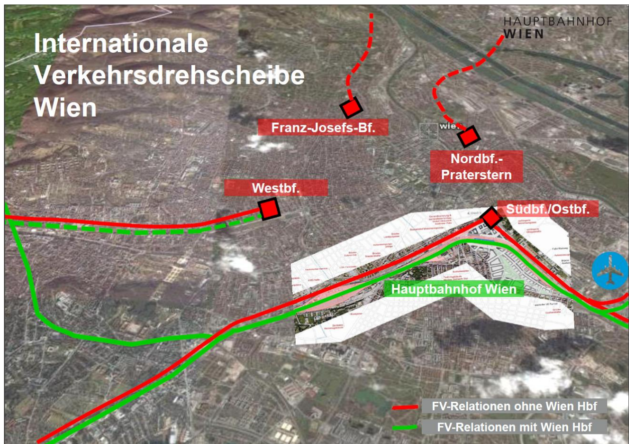
Fig.8-Schema liniilor de cale ferată în varianta veche, cu roșu și în varianta nouă, cu verde, în noua stație principală din Viena, ca rezultat al transformării celor două stații terminus, de est și de sud.
