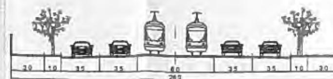
A'-A' Reglementare supralargire Soseaua Colentina PROFIL TRANSVERSAL PROPOS DUPA SUPRALARGIRE
