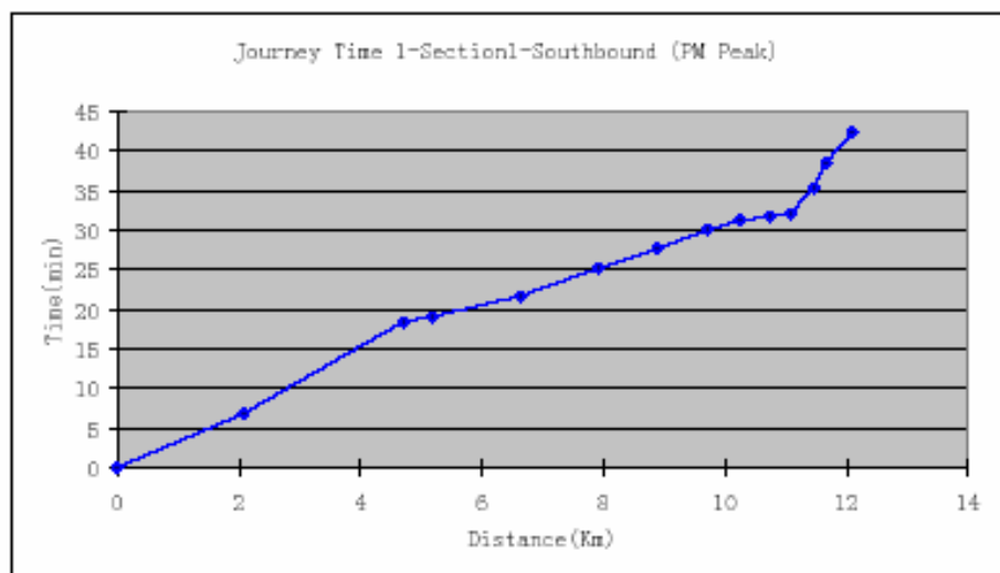
Figura 6-10 Sondajul privind relația durată-distanță pe axa nord-sud: limita Bucureștiului - Universitate – oră de vârf, după-amiază
