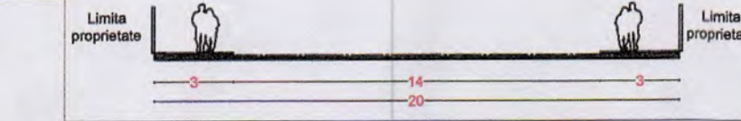
DD - Profilul strada propusa cu caracter orientativ pentru reconfigurarea profilului transversal si trecere in domeniul public
