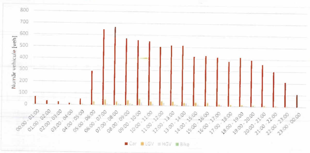
Figura 1.1-32. Valori de trafic 17_Drumul Sării_Nord
