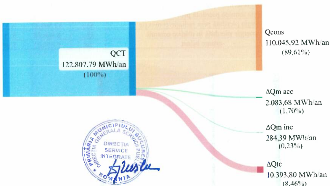
Figura 12.2 – Diagrama Sankey pentru regimul real de funcționare a rețelei de distribuție aferentă CT de cvartal
