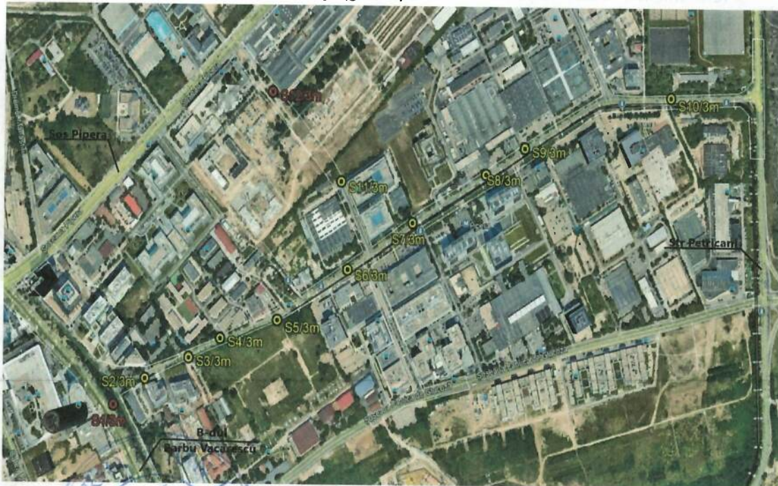
Figură 89 - amplasamente sondaje geotehnice
