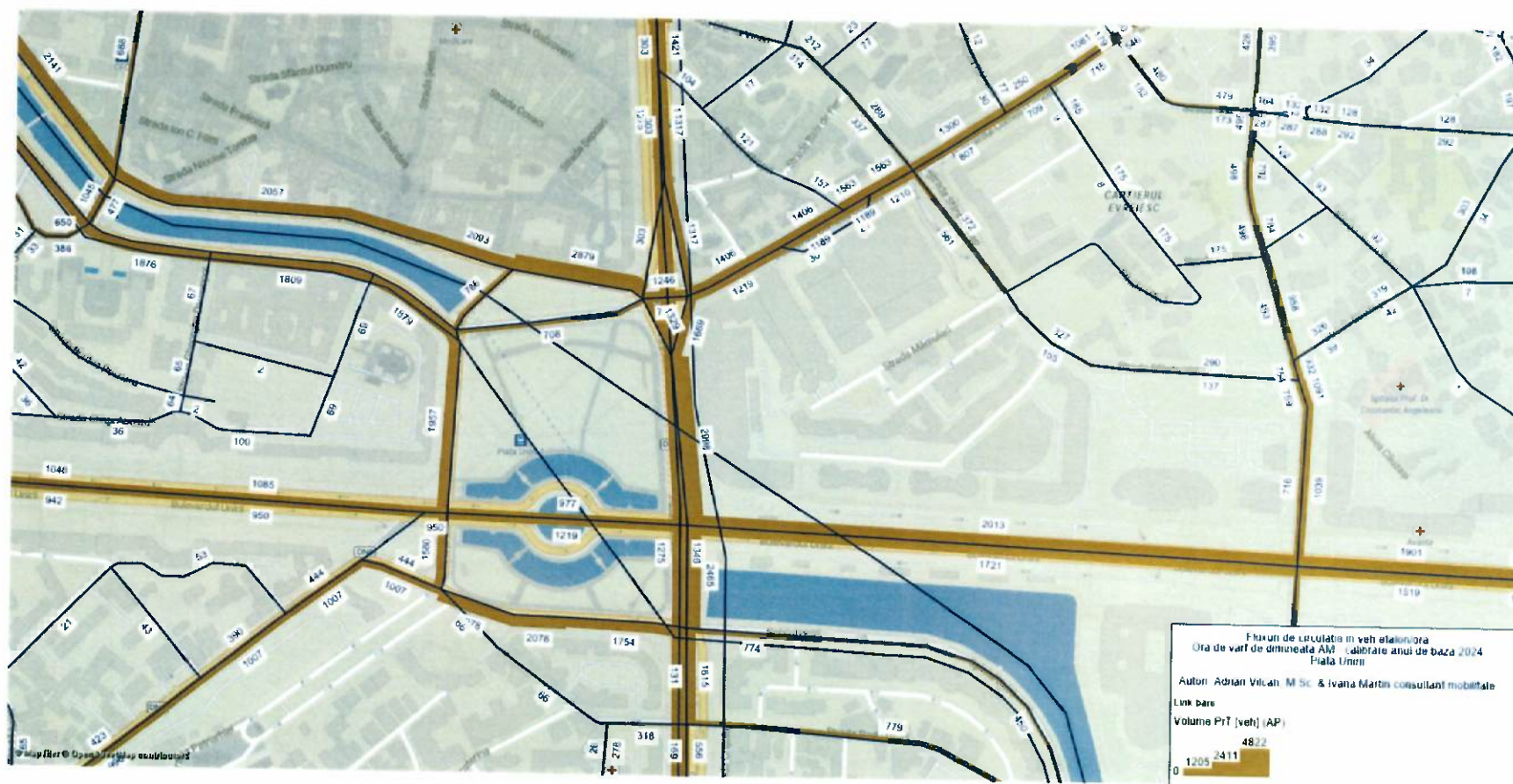
Fig. 3 - Debite de trafic - situația actuala de circulație ora de vârf de dimineață AM - vet/ora
