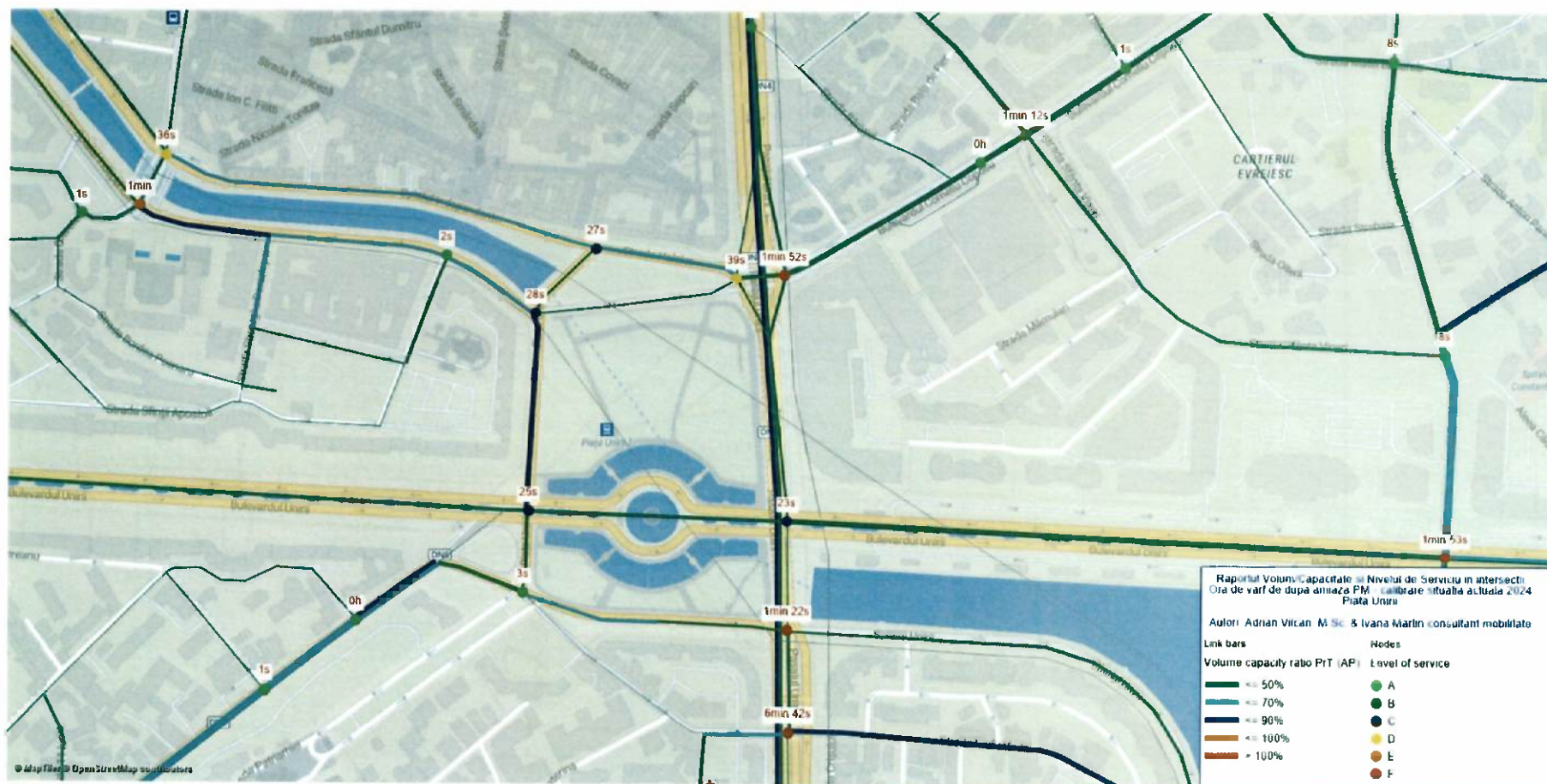
Fig. 10 - Întârzieri si Nivelul de Serviciu in intersectii - Raportul Volum/Capacitate pe bara dintre intersectii - situația actuala de circulație ora de vârf de după amiaza PM
