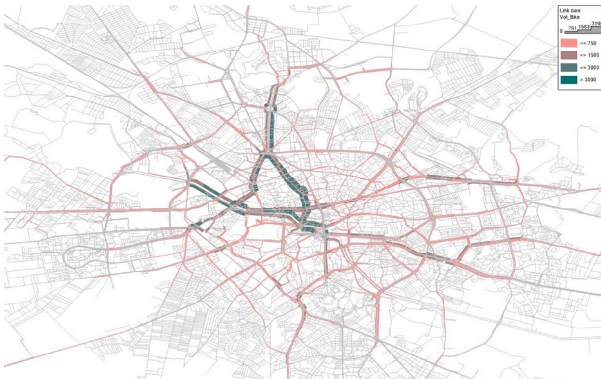
Figură 3-16 Fluxuri velo simulate cu ajutorul modelului de transport realizat pentru Masterplanul Velo al Municipiului București
