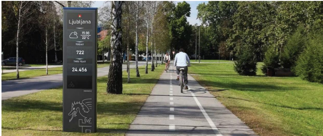
Figură 7-61 -Implementarea unui totem de centralizare și numărare a fluxurilor de bicicliști pe un anumit traseu (sursă count-matic.com)
