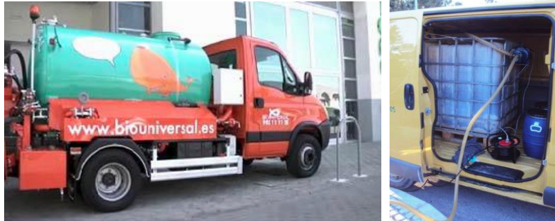
Figura 7-15 Tipuri de camioane și furgonete pentru transportul uleiurilor uzate din punctele de colectare
