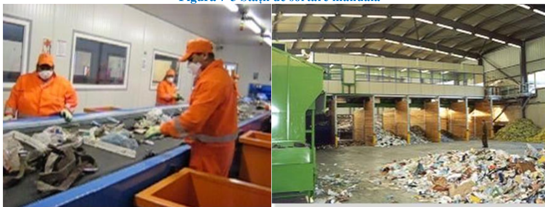
Figura 7-3 Stații de sortare manuală
