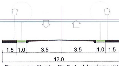
Str. erou Ion Floruta - Profilul stradal reglementat
