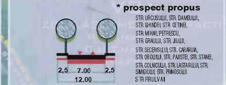
Sectiune transversala - ARTERA LOCALA PROPUSA
